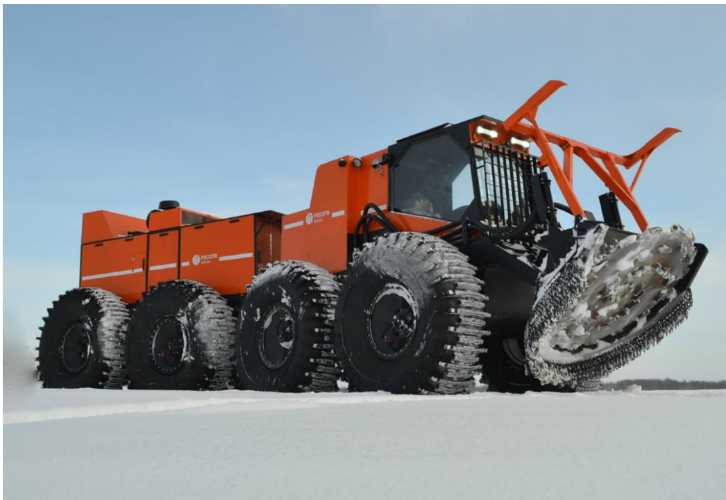
Снегоболотоход Тром 20 УЭС оснащенный мульчерной головкой фрезерного типа мощность 240л.с. ширина захвата 1,5 м.
