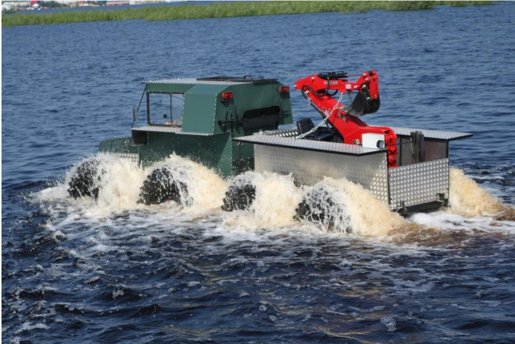
Снегоболотоход Тром 8 оснащенный экскаватором УЭ-225 глубина 2,25 м, усилие 1,7тонн.
